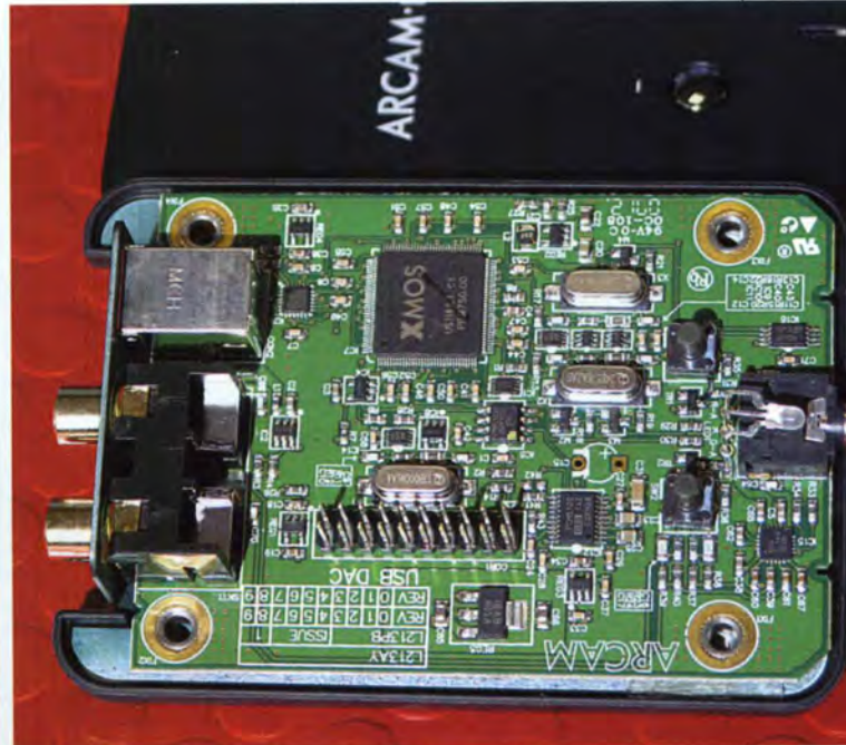
All'interno dell'rPAC l'integrato più evidente è il processore Xmos che controlla il transceiver USB SMSC USB3318 per realizzare il funzionamento asincrono sulla connessione USB.
